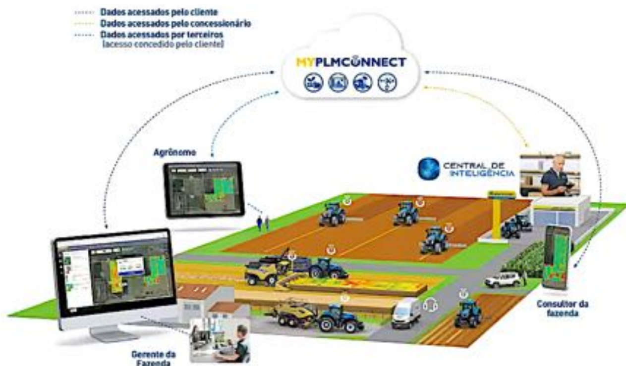
Figura 03 – Representação do portal de telemetria da New Holland na forma da nuvem “My PLM Connect”, rede de transferência de dados entre o “cliente”, sua equipe (“gerente da fazenda” e “consultor da fazenda”), a “central de inteligência” (o “concessionário”) e “terceiros” (o “agrônomo”). Fonte:
